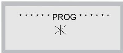
Nach Betätigung der
