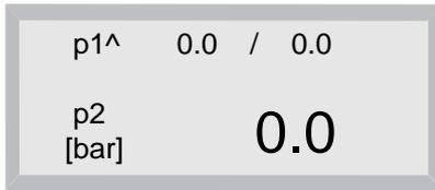
Die Extremwerte für den Druck (min.- max. Werte) von p1 und p2 werden kontinuierlich in einem Hintergrundspeicher abgelegt und auf Wunsch des Bedieners in der Anzeige dargestellt.
