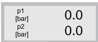
Arbeitet der Drucksensor korrekt, erscheint die normale Meßwertanzeige (siehe linkes Bild) ohne die waagerechten Linien.
