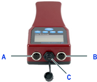
A Canale di misurazione 2 C Interfaccia USB B Canale di misurazione 1
