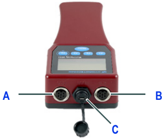
A Canal de mesure 2 C Interface USB B Canal de mesure 1
