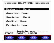
Durch Drücken der Taste wird aus dem Hauptmenü das Meßkanal-Menü aufgerufen.
