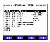
Sofort erscheint in unserem Beispiel das Meßkanal-Menü, in dem alle Meßkanäle sowie Trigger-Ein- und Ausgang und Berechnungs-Kanäle angewählt werden können. Bei aktiviertem ISDS im Gerätemenü werden alle angeschlossenen ISDS-fähigen Sensoren automatisch nach dem Einschalten vom Meßgerät erkannt.
