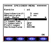
Eine Triggerung auf ein externes Signal z. B. aus einer SPS-Steuerung oder einem digitalen Ventil ist eine nützliche Ergänzung, wenn der Startzeitpunkt einer Speicherung von einer externen Maschinensteuerung erfolgen soll.
