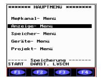
Nach Auswahl der entsprechenden Zeile und durch Drücken der Taste wird aus dem Hauptmenü das Anzeige-Menü aufgerufen.
