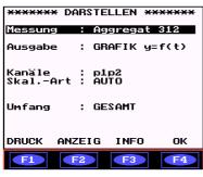
Im linken Bild ist in unserem Beispiel die Meßreihe "Aggregat 312" für die Darstellung einer Grafik ausgewählt. Es wurden aus der Meßreihe die Kanäle p1 und p2 ausgewählt und die Skalierungsart auf automatische Skalierung (AUTO) eingestellt. Als Umfang soll die die gesamte Meßreihe in die Darstellung einbezogen werden.
