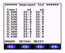
In einem weiteren Bild ist der neue Bereich zwischen 0,5 und 0,6 s dargestellt. Auch dieser Bereich wurde wieder in 10 identische Abschnitte unterteilt. Die Detaildarstellung kann beliebig oft durchgeführt werden. Der Darstellbereich einer Detaildarstellung kann auch über die Pfeiltasten beliebig verschoben werden.
