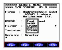
In der Auswahlzeile "RS232" wird die Baudrateneinstellung aufgerufen. Über eine der Pfeiltasten kann die gewünschte Baudrate\*) ausgewählt werden.
