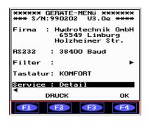
In der Auswahlzeile **"Kanalfilter"** kann ein Softwarefilter eingestellt werden. Die Analogeingänge werden mit 1 ms (1 kHz) abgetastet. Über einen einstellbaren Softwarefilter (1-2-4-8-16 ms) kann eine Glättung der Meßwerte durch eine Mittelwertbildung aus
