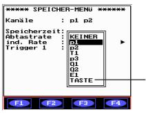
Als Triggerkanal stehen die Meßkanäle, eine manuelle Triggerung über "Taste" (F4) und der externe Triggereingang E1 zur Auswahl.
