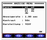
Ein weiteres Drücken der Taste ruft das Menü "Kanalauswahl" zur Auswahl der Kanäle für die Anzeige auf.
