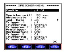
Unser Beispiel zeigt die Triggerung mit zwei Messgrößen (p1 und Q1) und einer UND-Verknüpfung. Damit Sie bei manueller als auch bei interner Triggerung eine gespeicherte Messreihe erhalten, die tatsächlich Ihren Wünschen bezüglich der Aufzeichnung vor und nach einem Triggerereignis entspricht, sind folgende Bedingungen einzuhalten:
