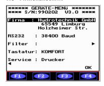
In der Auswahlzeile "**Firma"** kann mittels der Pfeiltaste eine Textabänderung auf die Firmenanschrift des Anwenders durchgeführt werden.
