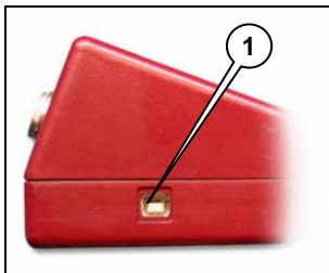
Fig. 4 : Raccordement de micro-ordinateur (USB)
