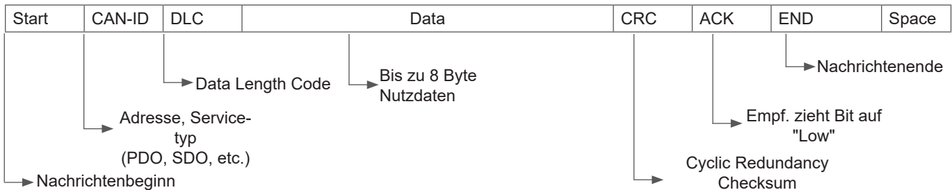
Abbildung 14: CAN Nachrichtenformat
